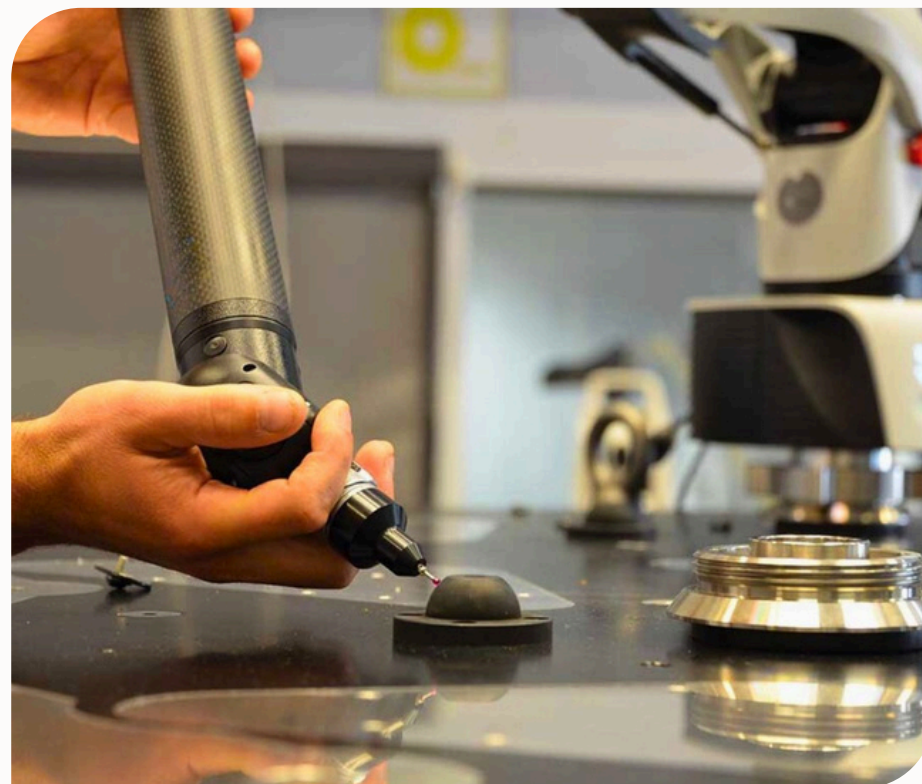
Controllo dimensionale con braccio di misura 3D.
